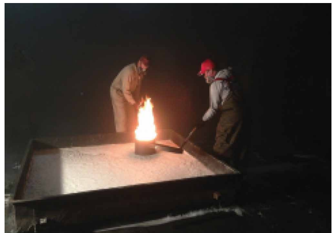
Los técnicos llevan a cabo una prueba de resistencia a la reignición
