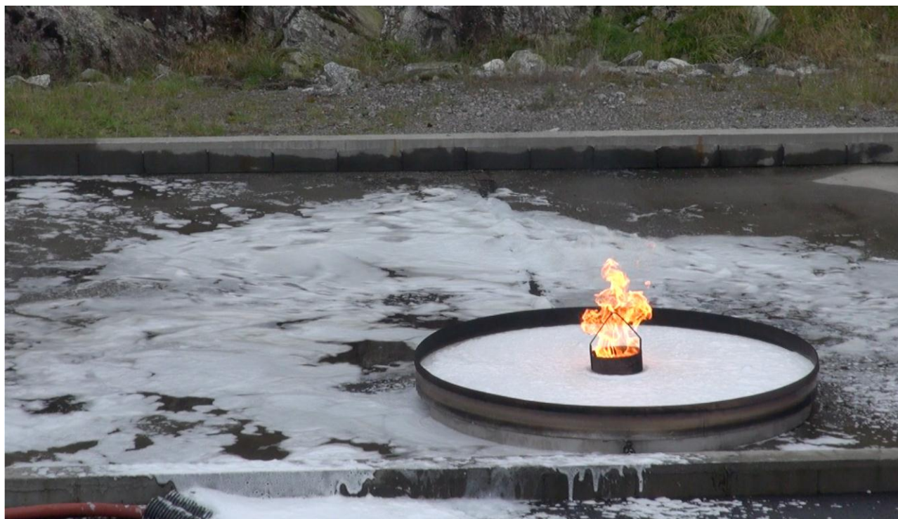
Test pour la certification OACI de la mousse SOLBERG® RE-HEALING™ – Bergen, Norvège
