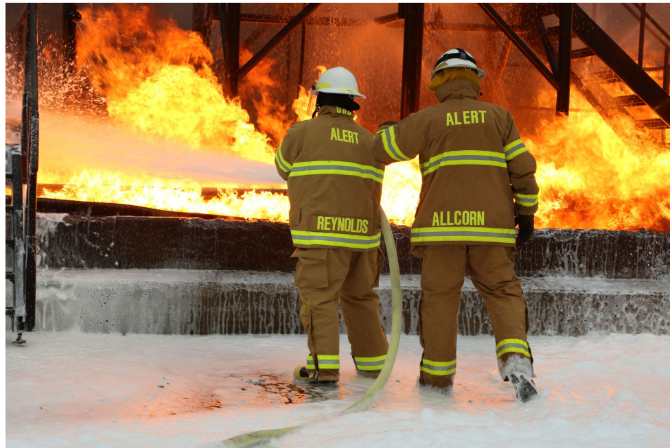
Alert Disaster Control-Löschmannschaft führt den fluorfreien RE-HEALING Schaum an einem Kohlenwasserstoff Brand der Klasse B im BEST Komplex - Beaumont, Texas, vor.
